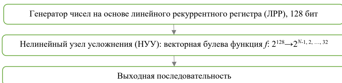
Рис. 1. Структура генератора псевдослучайной последовательности
